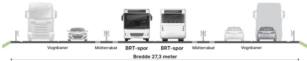
Figur 5. Principskitse for midterlagt BRT-tracé (Kilde: COWI).
