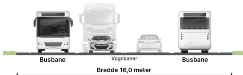
Figur 7. Principskitse for sidelagte busbaner (Kilde: COWI).
