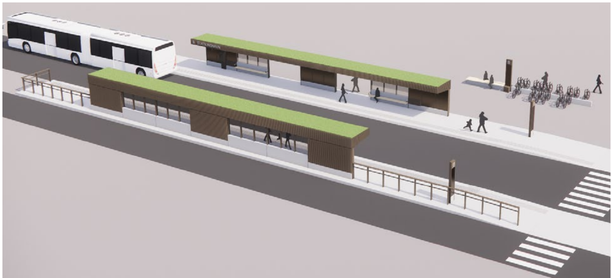
Figur 10. Skitse af stationskoncept med perroner placeret over for hinanden.
